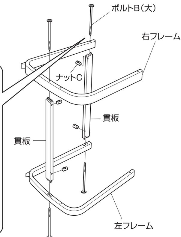
**4** 左右フレームの間に固定した背フレームを入れて、ボルトD(中)で背フレームを左右4ヶ所固定します。背フレームを固定した後に貫板を仮止めしたボルトB(大)4ヶ所をしっかりと固定してください。
